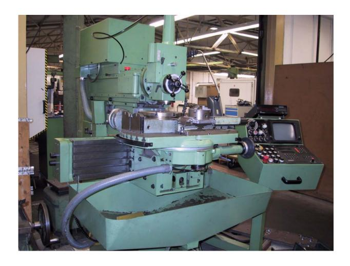
Bearbeitungswege (x, y, z) : 600 x 400 x 400 mm Hauptspindellage : Horizontal / Vertikal
