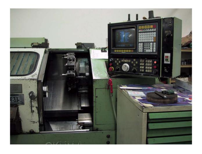
Drehdurchmesser Spitzenteile :  $\varnothing$  240 x 520 mm (über Bett  $\varnothing$  350)
