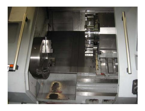
Drehdurchmesser Spitzenteile : Ø 700 x 2035 mm (über Bett Ø 900)
