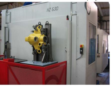
Palettengröße / Schwenkkreis :  $800 \times 630 \text{ mm} / \text{Ø} 1080 \text{ mm}$ Bearbeitungswege (x, y, z, B) :  $1010 \times 800 \times 1010 \text{ mm}$ ,  $360^{\circ}$
