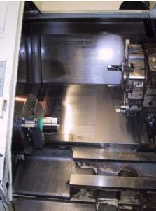
Drehdurchmesser Spitzenteile :  $\varnothing$  450 x 1250 mm (über Bett  $\varnothing$  630)
