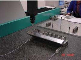
Messbereich (x, y, z) :  $2500 \times 1000 \times 800 \text{ mm}$ Messunsicherheit :  $U1 = 1,7 + (L/450) \mu m$ (VDI 2617, E in ISO 10360-2)  $U3 = 2,2 + (L/400) \mu m$
