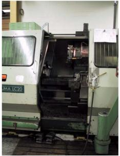
Drehdurchmesser Spitzenteile :  $\varnothing$  320 x 400 mm (über Bett  $\varnothing$  440)
