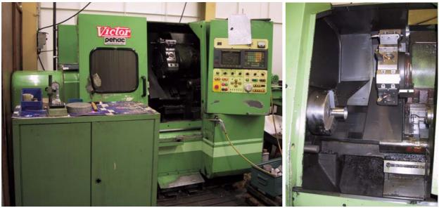
Drehdurchmesser Spitzenteile : Ø 260 x 300 mm (über Bett Ø 350)
